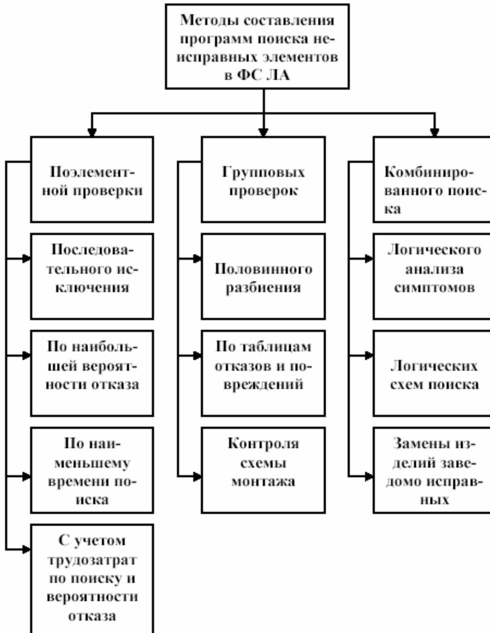
Рис. 2.1. Основные методы поиска неисправных элементов в ФС ЛА
