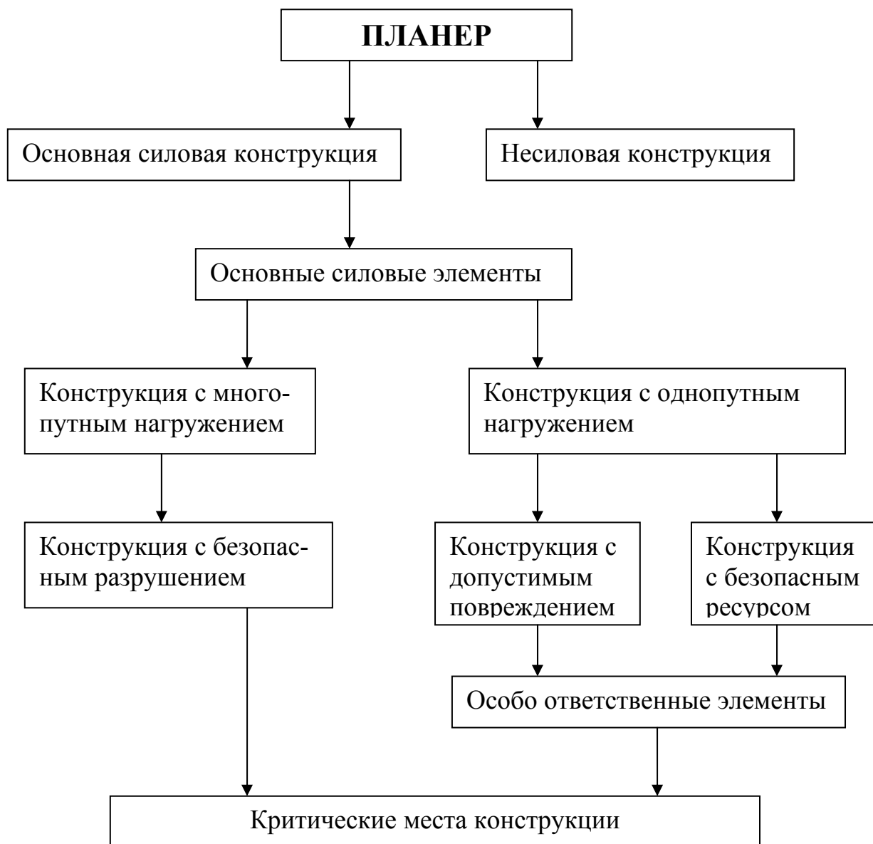
Рис. 5.2. Классификация элементов конструкции планера
