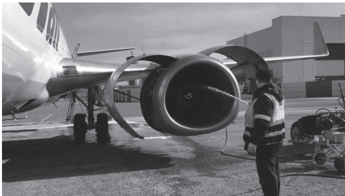
Рис. 8. Традиционный метод очистки проточной части двигателя самолета
