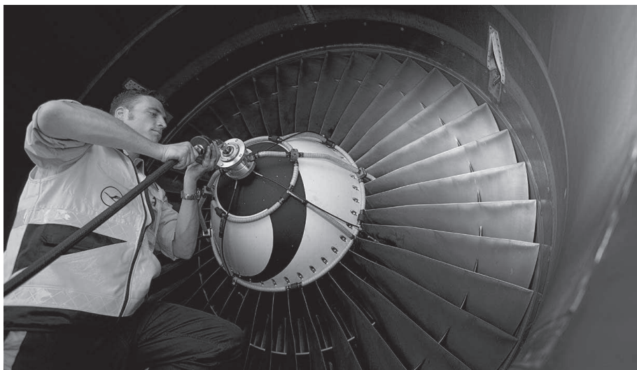
Рис. 10. Установка моющего оборудования «Cysclean» на ГТД самолета
