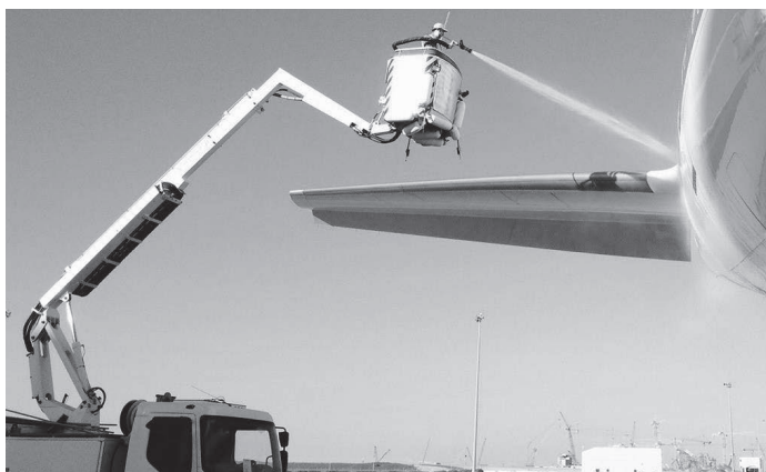
Рис. 5. Общий вид спецмашины «Vestergaard Elephant Му» во время облива водой ВС в процессе мойки
