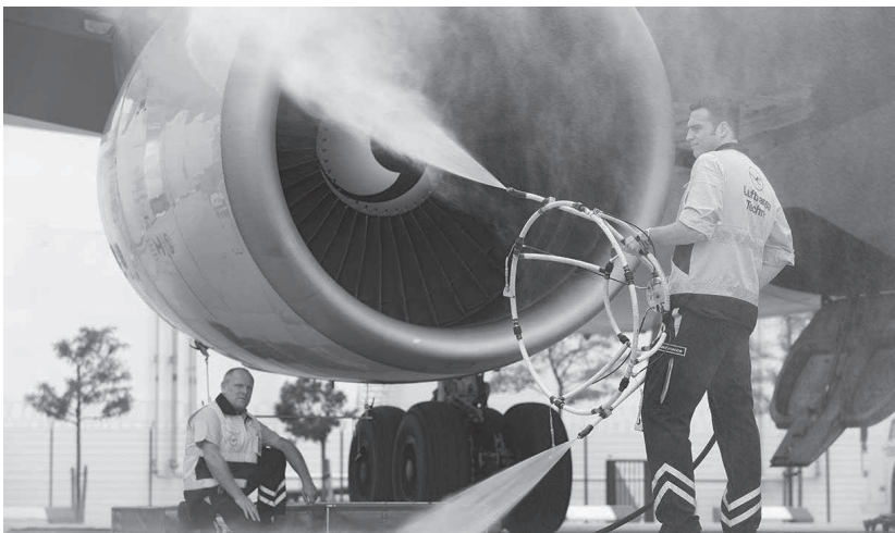
Рис. 9. Специальная установка «Cysclean» применяемая для очистки проточной части ГТД самолета
