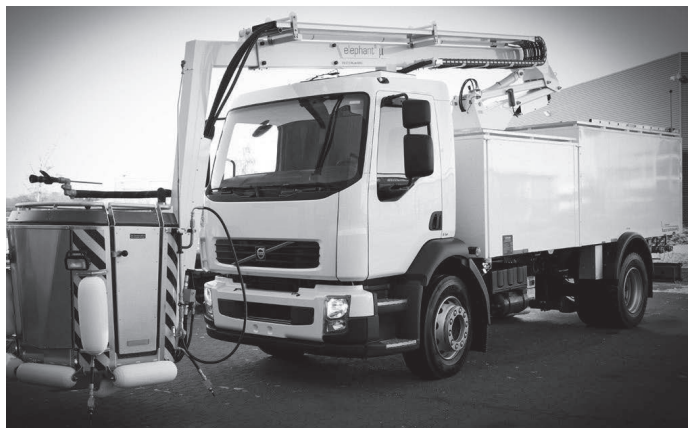
Рис. 4. Общий вид спецмашины «Vestergaard Elephant Му» для выполнения облива водой ВС в процессе мойки
