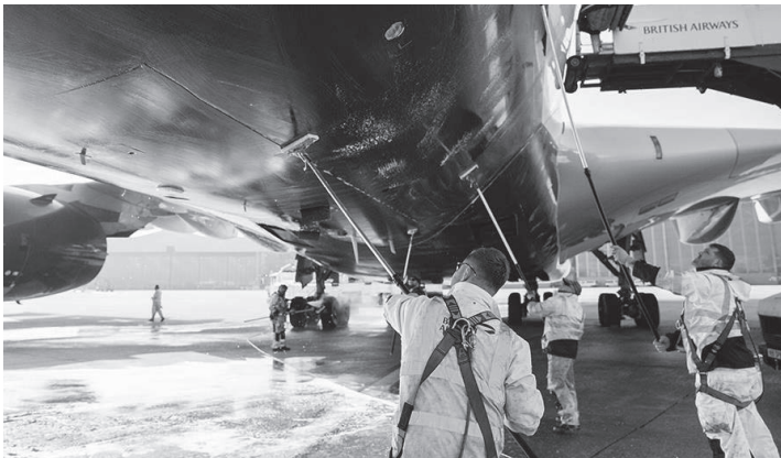
Рис. 1. Наружная мойка самолета ручным способом
