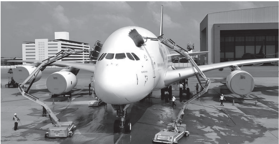
Рис. 3. Механизированная наружная мойка ВС с использованием спецмашин
