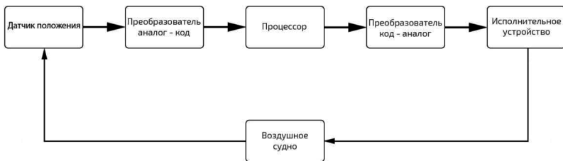
Рис. 1.1 Структурная схема цифровых вычислителей в контуре ВС
