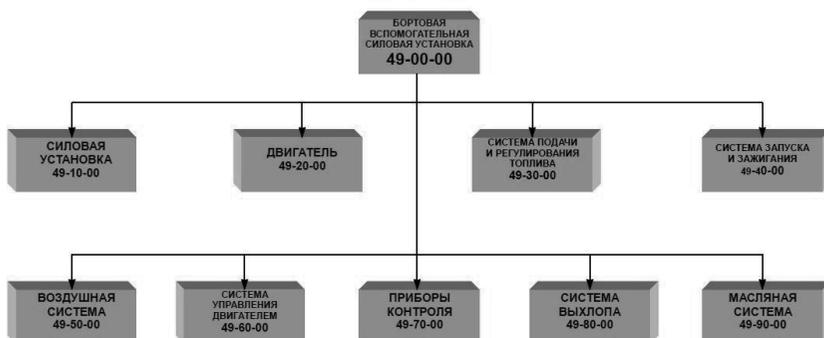
Рис. 6 Структурная схема системы бортовой вспомогательной силовой установки
