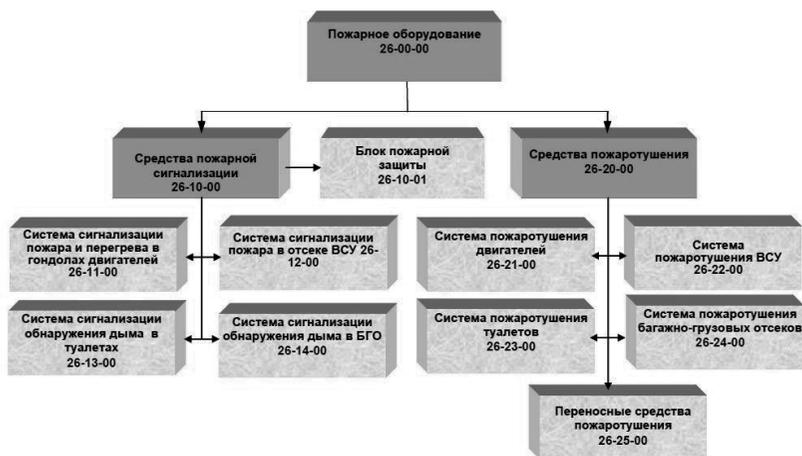
Рис. 7 Структурная схема противопожарного оборудования
