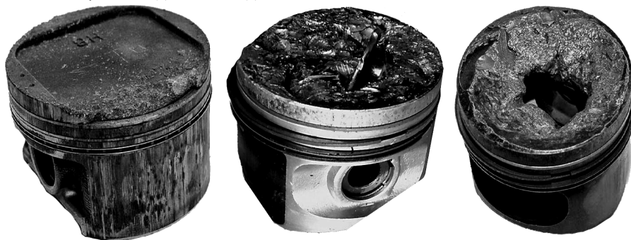
Рис. 1. Разрушение деталей в результате детонации
