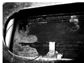
е) повреждения ЛКП элементов топливной системы ЛА
