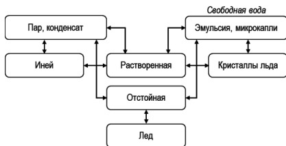
Рис. 1. Фазовые переходы воды в топливной системе ЛА
