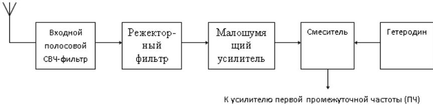
Рисунок 2.5. Схема входных каскадов ШСС
