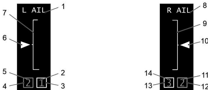
*Рисунок 18. Индикация состояния и положения элеронов*
