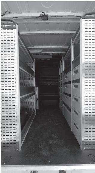
Рис.3. Размещение стеллажей в спецавтомобиле
