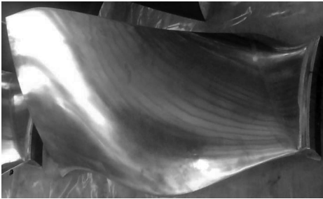
Рис. 8. Рабочая лопатка вентилятора
