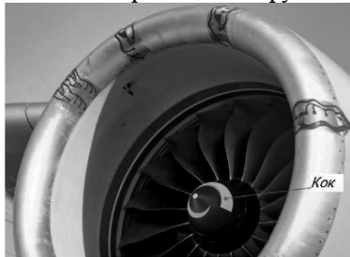
Рис. 11. Вид на входное устройство двигателя
