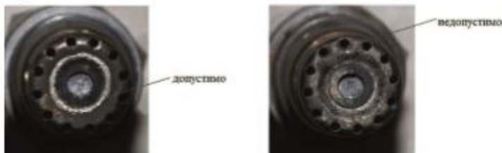
Рис. 3.10. Эрозия охлаждающих отверстий свечи
