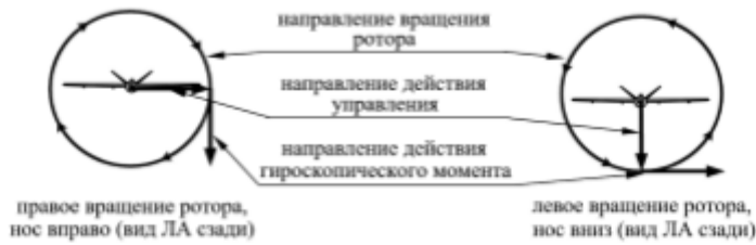
Рис. 9.4. Пример действия гироскопического момента
