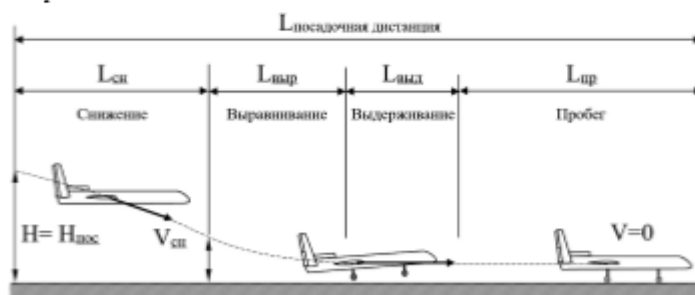
Рис. 7.5. Схема посадки БВС с пробегом
