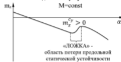
Рис. 10.5. Балансировочная диаграмма с областью неустойчивости по углу атаки
