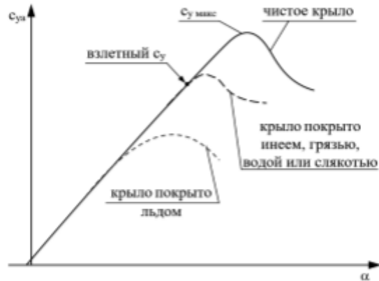
Рис.2.15. Влияние состояния поверхности на несущие свойства крыла
