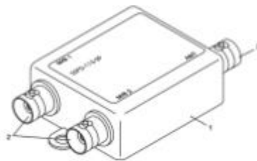
Рисунок 4.16 – Делитель сигнала антенны маркерной
