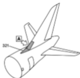
Рисунок 2.9 – Размещение антенна ДКМВ
