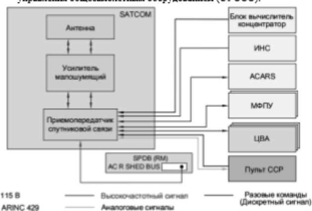
Рисунок 2.19 – Принципиальная блок-схема радиостанции спутниковой связи
