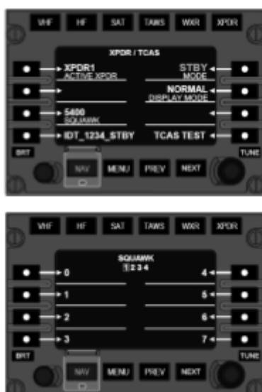
Рисунок 3.17 – Страницы настройки самолетного ответчика на МФПУ
