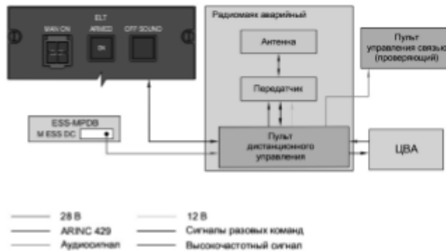
Рисунок 2.27 – Принципиальная блок-схема радиомаяка аварийного
