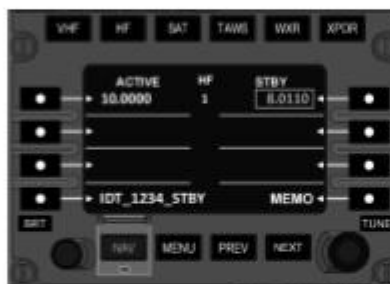
Рисунок 2.12 – Настройка резервной частоты
