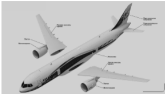
Рисунок 1.2 – Схема деления самолета MC-21-300 на основные составные части.
