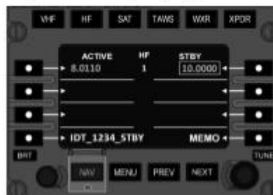
Рисунок 2.13 – Настройка резервной частоты
