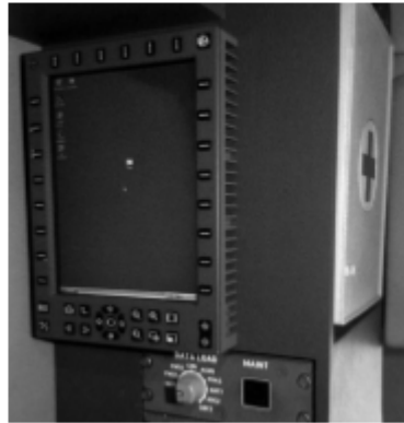
Рис. 3.1. Фотография дисплея EFB/MAT и пульта управления БСТО
