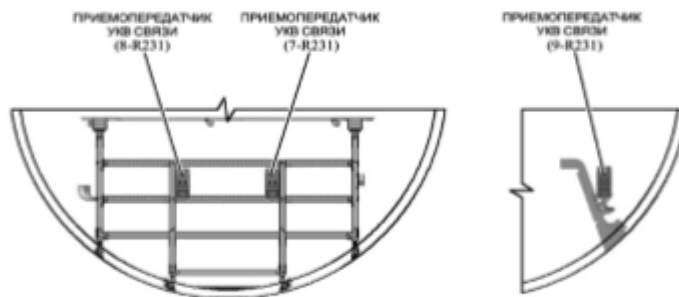
Рис.1.3. Расположение приемопередатчиков ОВЧ связи в технических отсеках самолета
