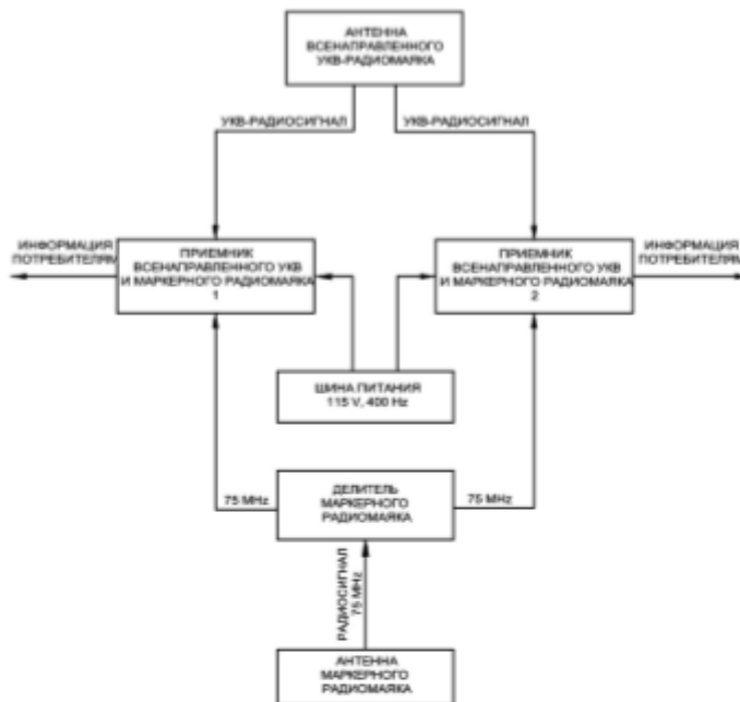
Рис.2.53. Функциональная схема связи элементов системы всенаправленного УКВ и маркерного радиомаяков
