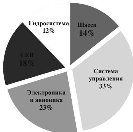
Рисунок 4.2. Функциональные системы, нарушение работоспособности которых привели к инцидентам
