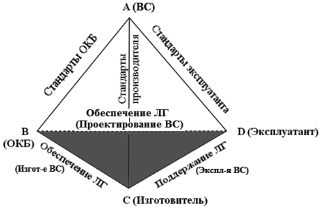
Рисунок 2.1. Модель (пирамида) лётной годности ВС: участники Системы обеспечения и поддержания лётной годности ВС: экземпляр ВС (A) – вершина пирамиды; разработчик - ОКБ (B), изготовитель (C), эксплуатант (D) – основание пирамиды
