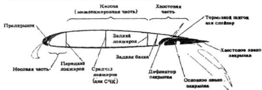
Рис. 3.12. Схема поперечного сечения крыла самолета Ил-76ТД
