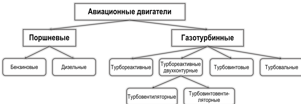
Рис. 3.3. Классификация авиационных двигателей
