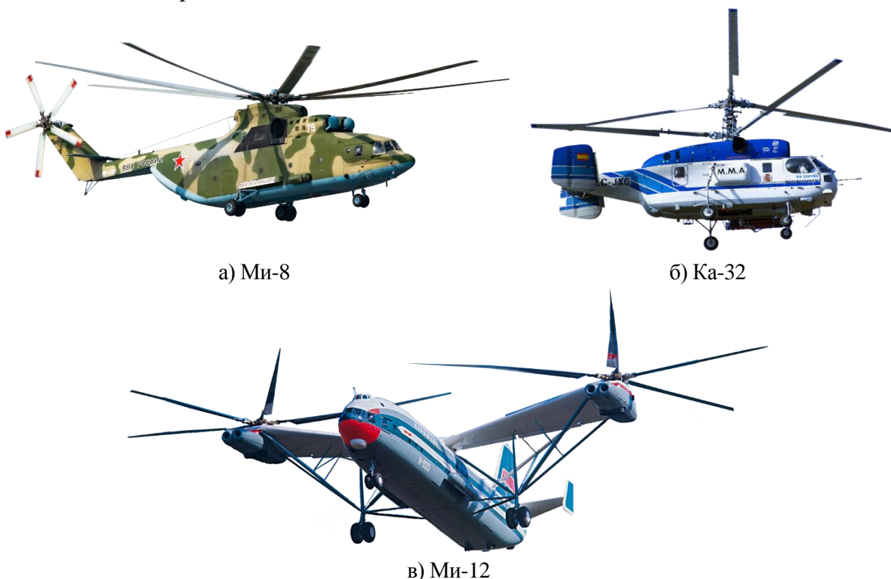
Рис. 3.2. Классификация вертолѐтов по количеству и расположению несущих винтов:
