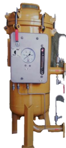
Рис. 5.3.19. Фильтр-водоотделитель вертикальный: P_{\text{раб}} 0,6 МПа; номинальная пропускная способность при н.у. 28 м 3 /ч
