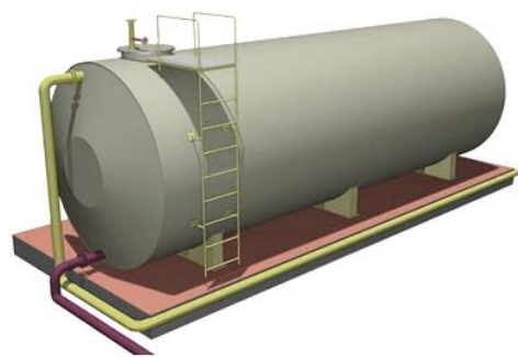
Рис. 5.3.5. Резервуар горизонтальный стальной (РГС)
