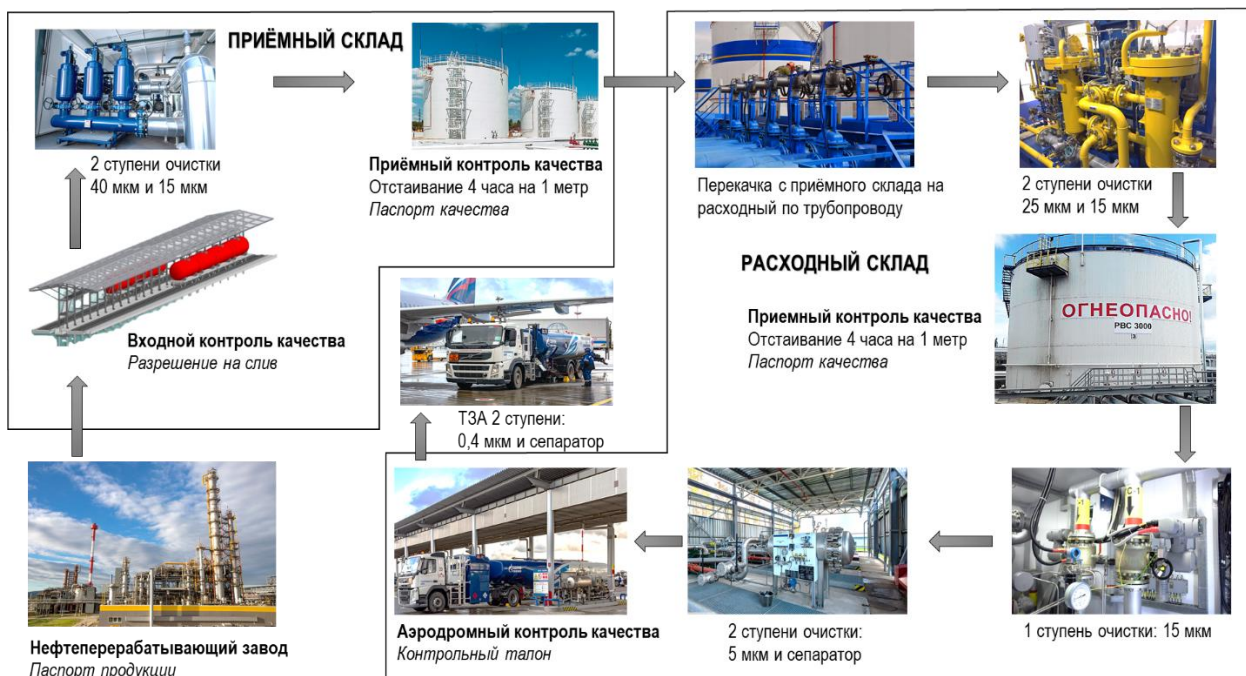
Рис. 5.4.1. Технологический цикл и контроль качества авиационного топлива
