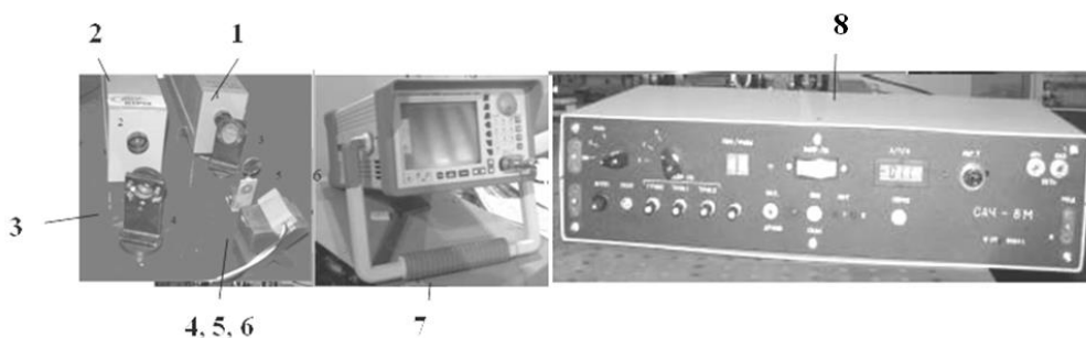
Рис. 7 Внешний вид образцовой установки ВНИИМ: 1 - исследуемый лазер; 2 - эталонный лазер; 3 - полупрозрачное зеркало; 4 - отражающее зеркало; 5 - фокусирующая линза; 6 - фотоэлектрический преобразователь; 7 - анализатор спектра; 8 - система автоподстройки частоты (АПЧ)
