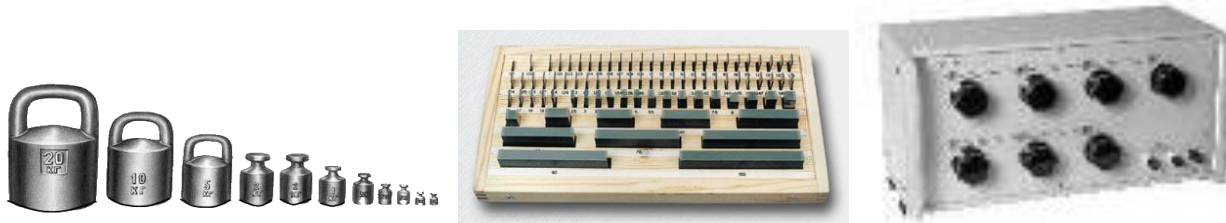
Рис. 15 Примеры мер а) гири б) концевые меры КМД №1 кл.1 в) Р3026/1 регулируемая мера электрического сопротивления постоянного тока
