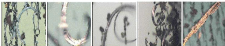
Рис. 36. Микрофотографии частиц износа при микрорезании (ув.500х)
