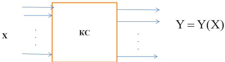
Рис. 2.7. Вид комбинационной схемы
