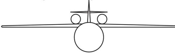
Рис. 1.9. Размещение двигателей над крылом в схеме высокоплана
