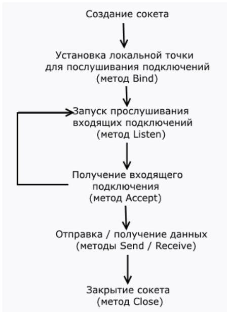
Рис1.- Схема работы серверного сокета TCP
