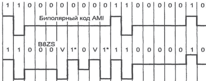
Рисунок 16. Пример кодирования B8ZS
