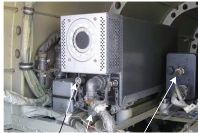
соединение с корпусом цепи питания ВЧ кабель антенны
