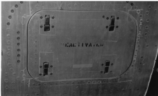
Рис. 13. Плохо заметные визуальные индикаторы корректного закрытия (верхние замки не полностью закрыты)
