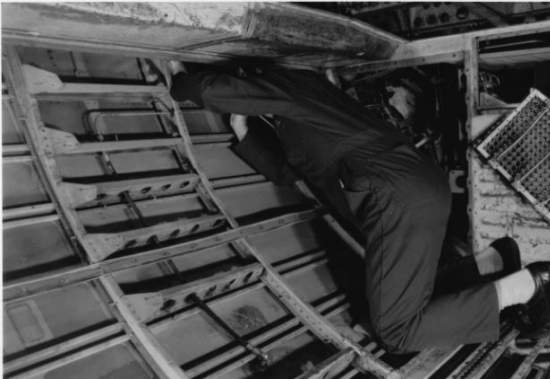
Рис. 11. Пример неудобного подхода (доступа) к объекту ТО из-за ограниченного пространства
