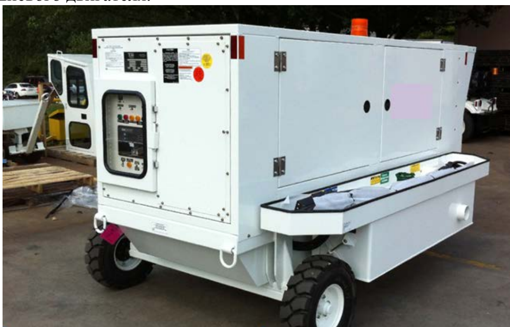
Рис. 15 Пример исполнения электроустановки на телеге
