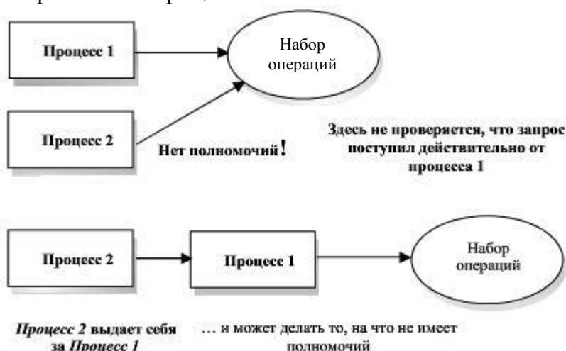
Рис. 3.2. Иллюстрация необходимости проверки подлинности субъекта в дополнение к проверке полномочий.
