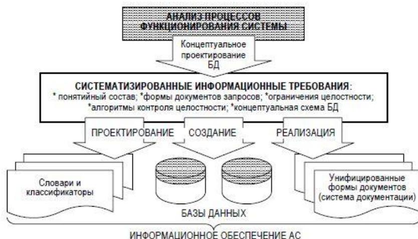
Рис.1.20. Взаимосвязь результатов проектирования БД с разработкой компонентов информационного обеспечения АС.
