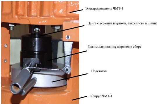
Рис. 2. Общий вид испытательного узла машины ЧМТ-1
