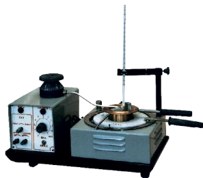
Рис. 1. Ручной прибор ТВО для определения температуры вспышки в открытом тигле
