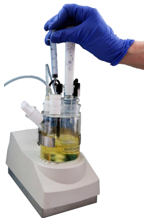
Рис. 4. Введение пробы топлива
