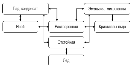
Рис. 1. Фазовые переходы воды в топливной системе ВС
