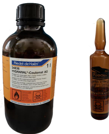
Рис. 3. Растворы для титрования: анодный (слева), катодный (справа)
