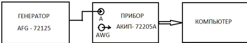
Рис.7. Структурная схема лабораторной установки
