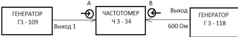
Рис.8. Структурная схема лабораторной установки.
