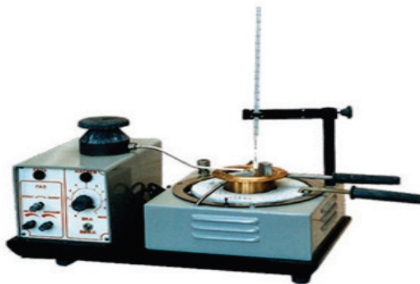
Рис. 3. Внешний вид прибора для определения температуры вспышки в открытом тигле по ГОСТ 4333
