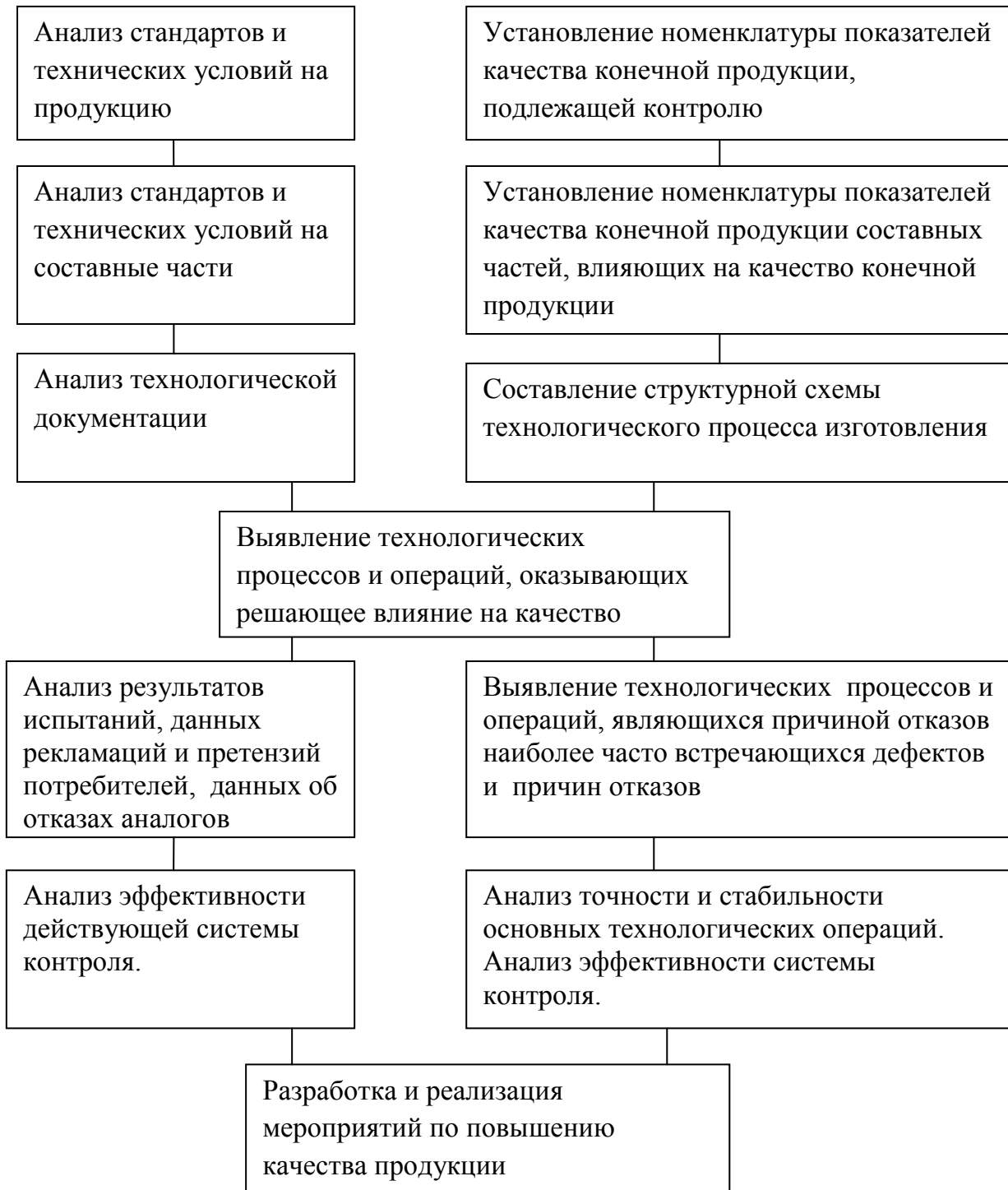
Рис. 2.5. Схема выявления параметров технологических схем, влияющих на надежность изделий
