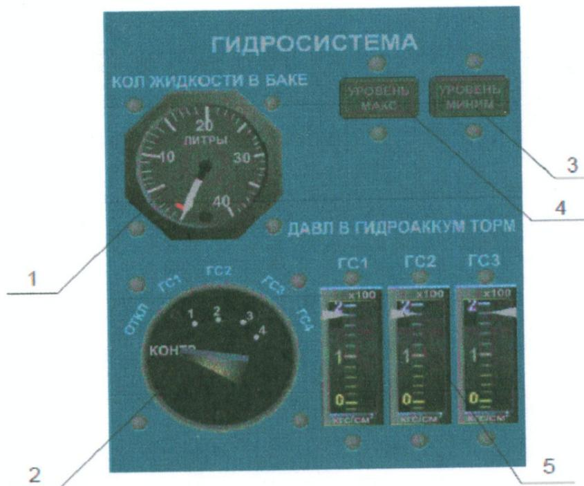
Рис. 7.6. Панель управления гидросистемой бортинженера:
