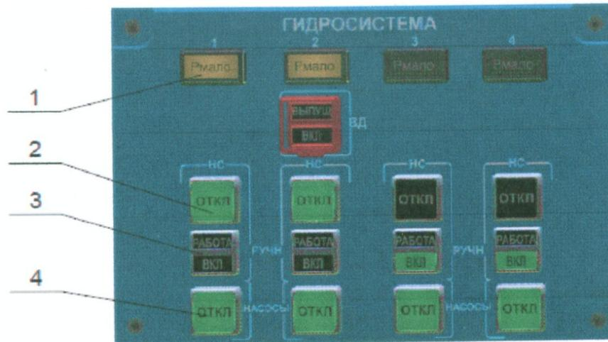
Рис 7.5. Панель управления гидросистемой на верхнем щитке пилотов:
