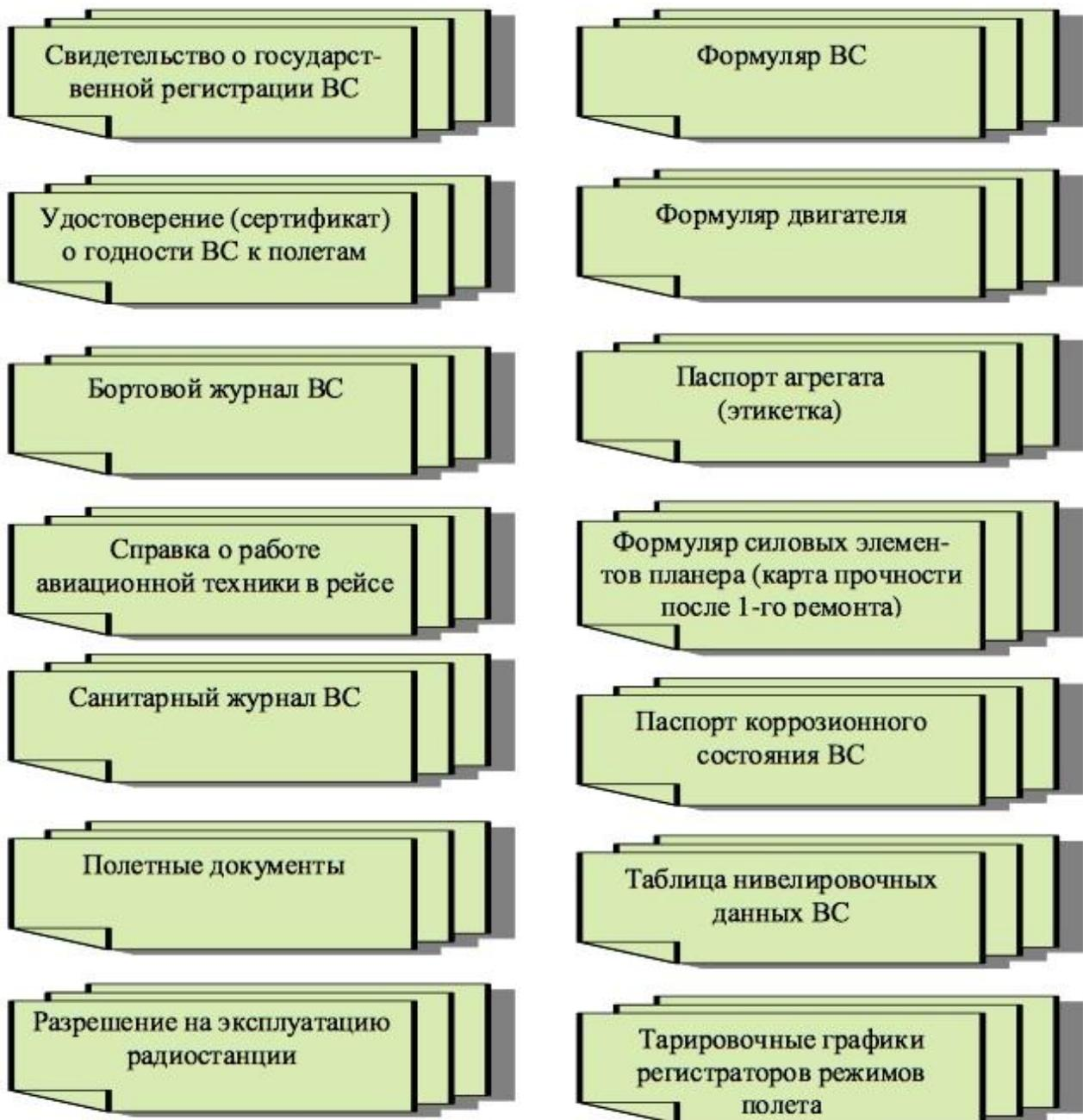
Рис. 2.5. Пономерная документация
