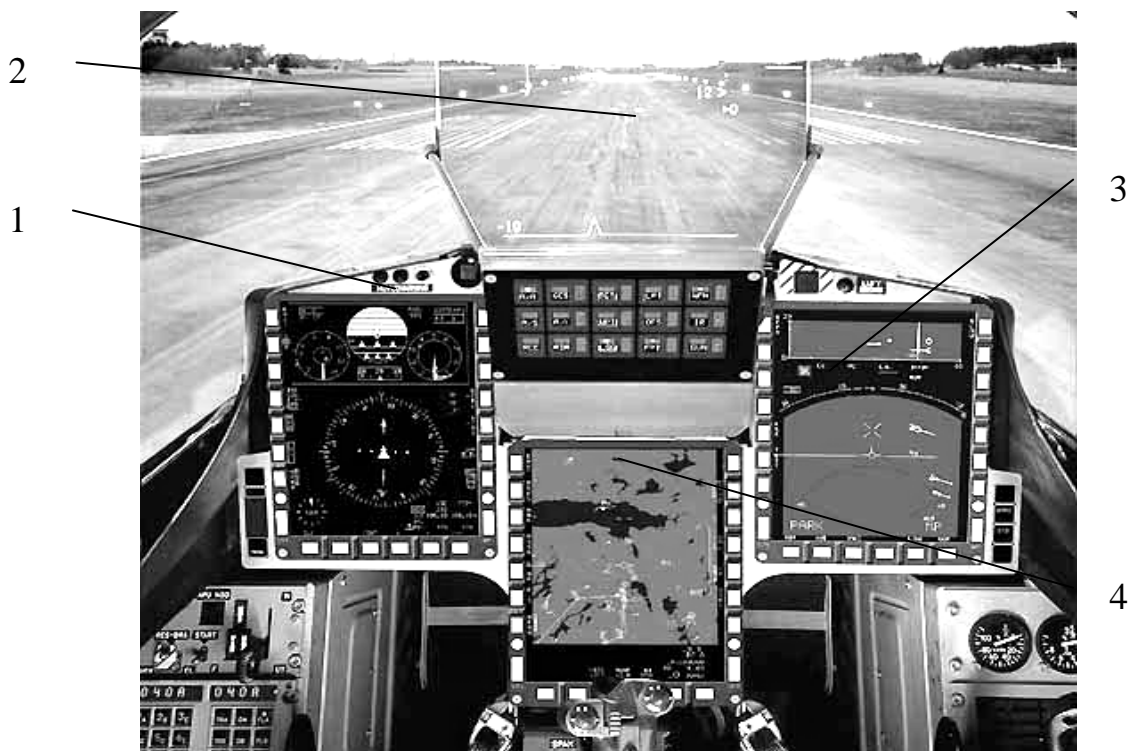
Рис.6.3. Устройства отображения информации истребителя JAS – 39: 1, 3, 4 – multifункциональные индикаторы; 2 – ИЛС
