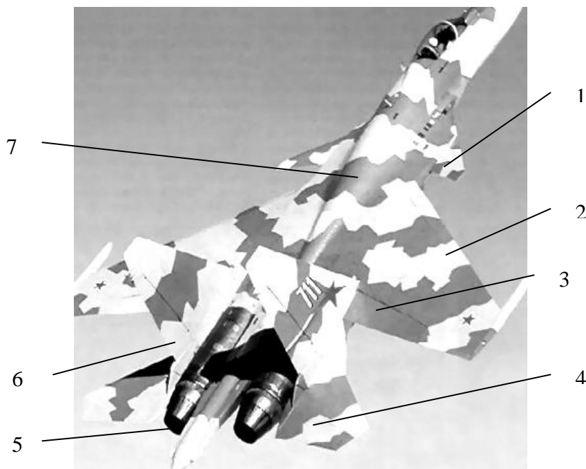
Рис. 0.2. Органы управления современного маневренного самолета:
