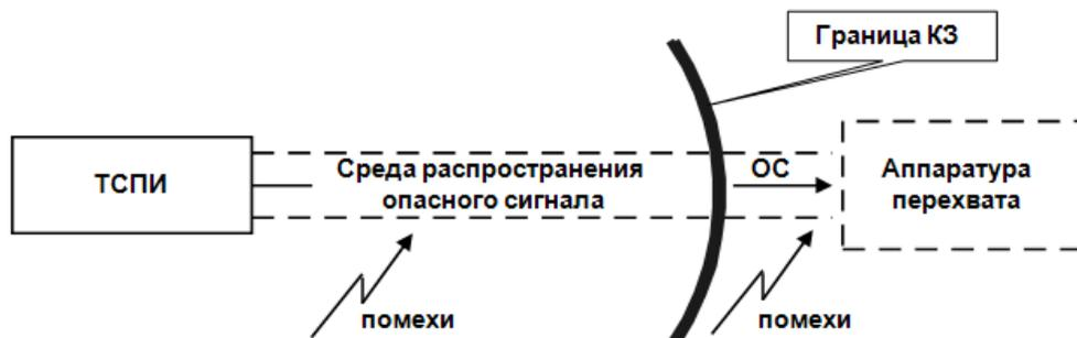
Рис. 4. Технический канал утечки информации
