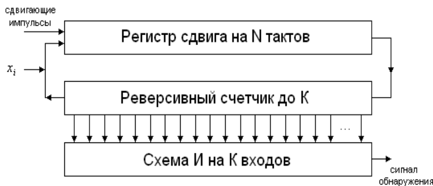
Рис.2.8. Структурная схема обнаружителя по критерию « K из N »
