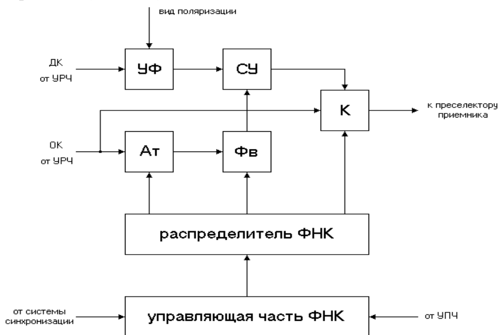
Рис. 2.6. Принцип действия формирователя нижней кромки зоны обзора в вертикальной плоскости
