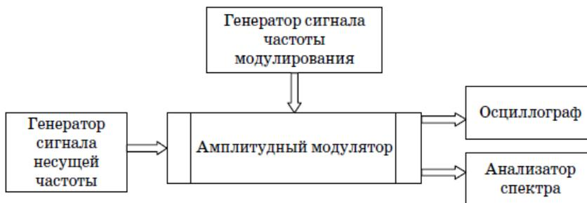
Рис. 3.2. Структурная схема исследования амплитудного модулятора
