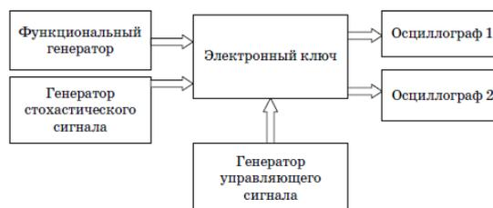
Рис. 6.4. Структурная схема исследования процесса дискретизации и квантования сигналов
