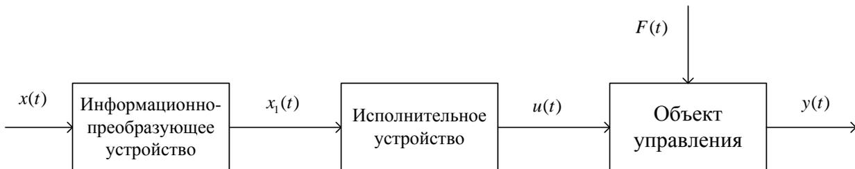
Рис. 16. Функциональная схема разомкнутой системы управления
