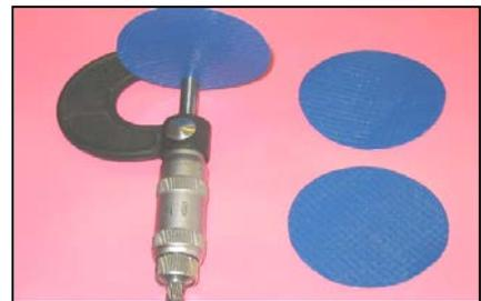
Конструкционный материал ЭР Измерение толщины образца и диффузионная ячейка
