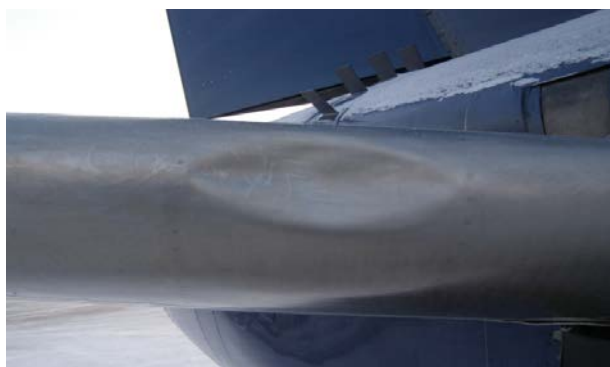
Рис. 3. Повреждение «лобовика» посторонними предметами
