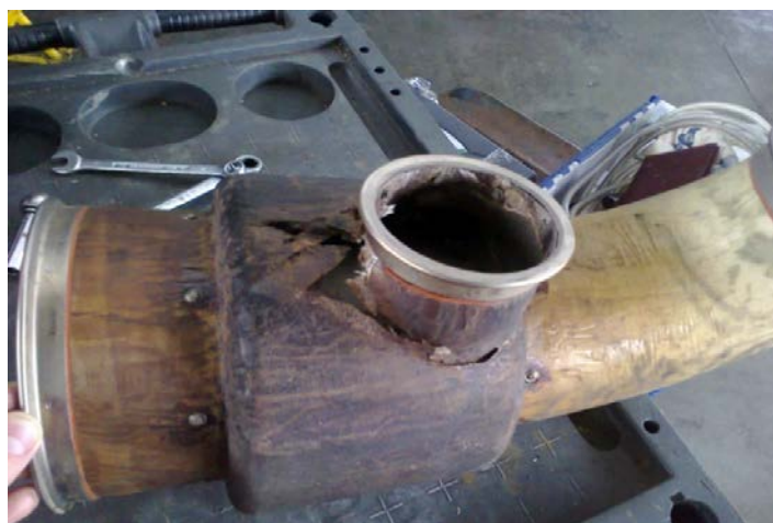
Рис. 2. Разрушение патрубка системы СКВ на самолете Боинг
