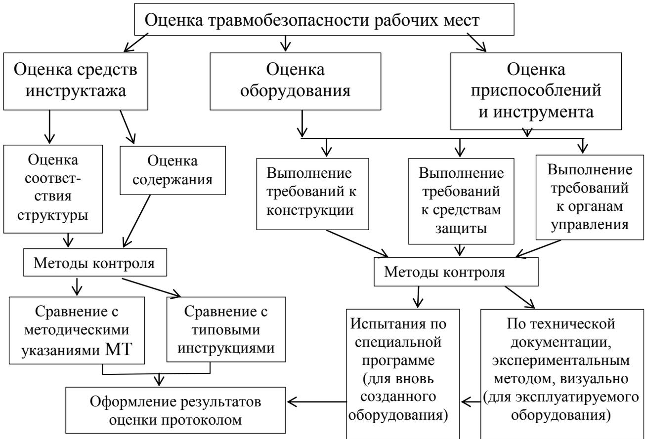
**Рис. 4.1.** Общая схема оценки травмобезопасности рабочих мест
