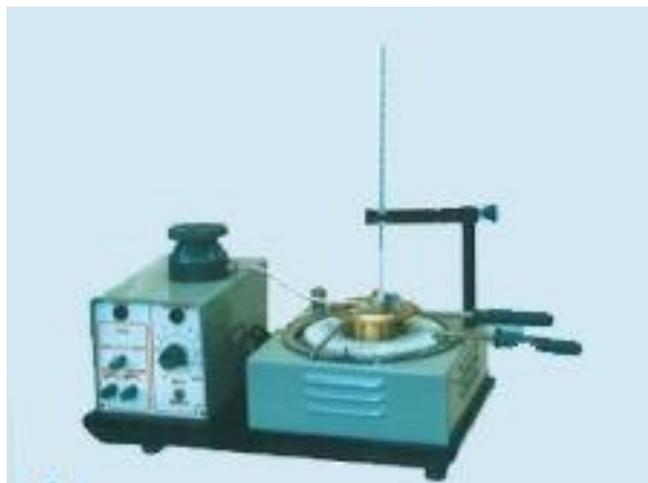
Рис.1 общий вид аппарата ТВО
