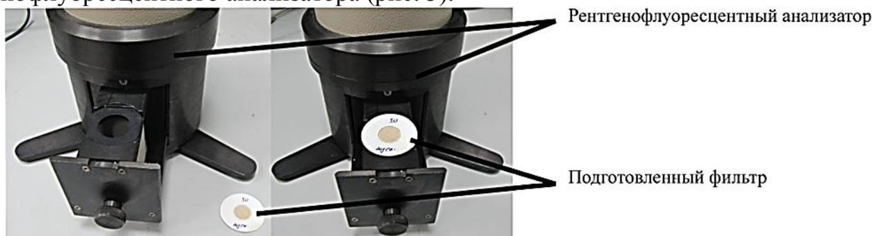
Рис. 3. Аналитический блок анализатора с фильтром
