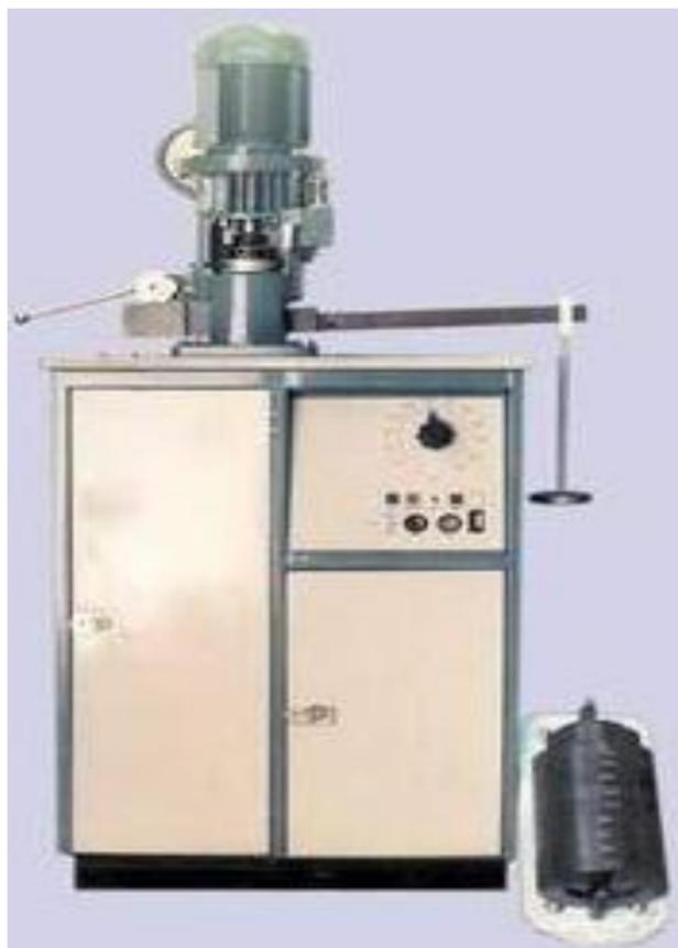
Рис. 1. Общий вид четырехшариковой машины трения ЧМТ-1
