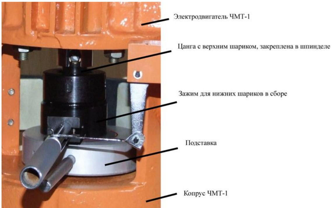
Рис. 2. Общий вид испытательного узла машины ЧМТ-1
