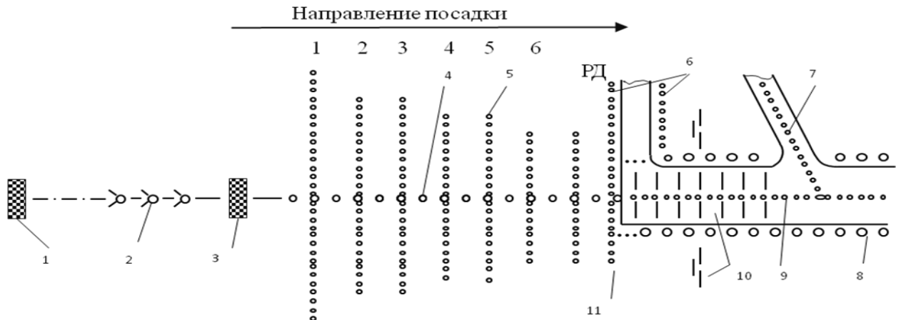
Рис. 9. Схема размещения основных элементов светосигнального оборудования: 1 – дальний приводной радиомаркерный пункт; 2 – огни приближения импульсного излучения; 3 – ближний приводной радиомаркерный пункт; 4 – огни приближения постоянного излучения; 5 – огни световых горизонтов (1...6 – номера горизонта); 6 – рулёжные огни; 7 – огни быстрого ухода с ИВПП; 8 – посадочные огни; 9 – осевые огни; 10 – огни зоны приземления; 11 – входные и ограничительные огни.
