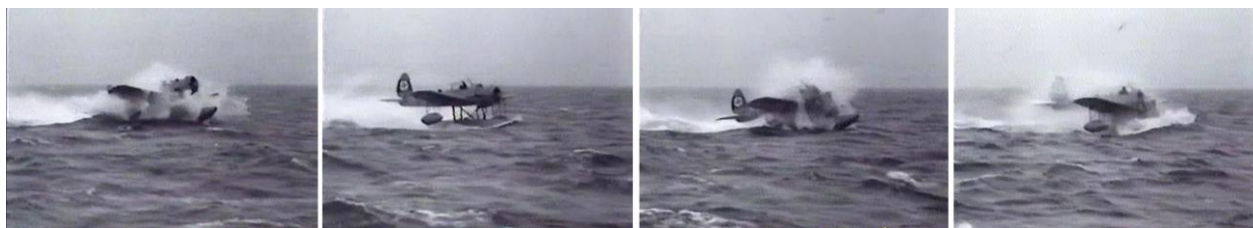
Рис. 2. Кинограмма аварии гидросамолета Arado Ar 196 в условиях волнения
