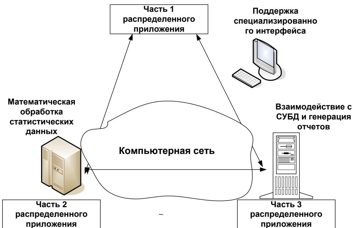
Рис.1.2. Схема взаимодействия распределенного приложения
