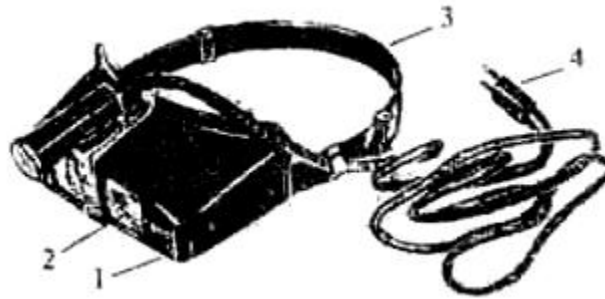
Рис. 4.6. Лупа БЛ-2 (бинокулярная налобная): 1 – корпус; 2 – лупа; 3 – регулируемый обод; 4 – электропровод с лампой.
