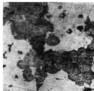
Рис.2.6. Микроструктура тростомартенсита: тростит (темный) и мартенсит (x300)
