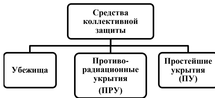
Рис. 8.2. Виды защитных сооружений
