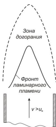
Рис. 4.5. Схематическое изображение пламени Бунзеновской горелки
